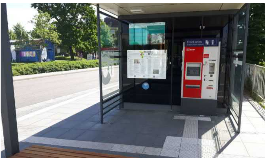
Die Medienwand am Haltepunkt Altstadt kombiniert den Fahrkartenautomaten, eine Vitrine und ein modernes Anzeige-Display mit den Abfahrtsangaben für Bahnen und Busse in Echtzeit.
